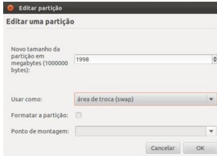
Figura 6 - Configurando a partição /dev/sda5 como a partição swap.
